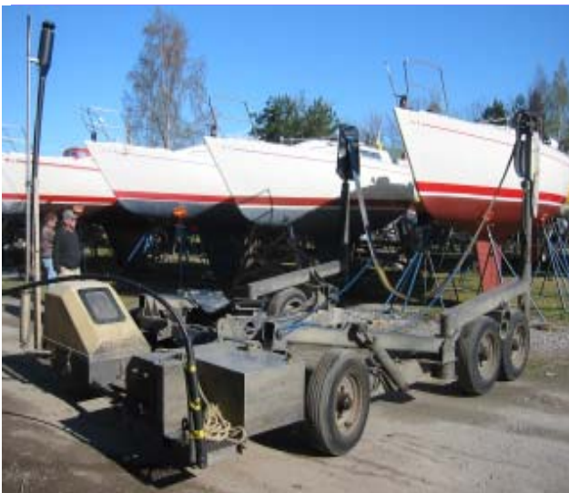
Dags för sjösättning - en Sublift underlättar sjösättningar och upptagningar.
